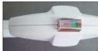
Applikator mit RF-Elektroden und Fenster für das IPL. Die Oberflächenkontaktkühlung ist im IPL-Fenster integriert.
